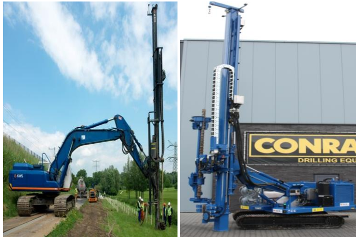
De machines waar het onderzoek mee wordt uitgevoerd: SBM10 C en Boxer 100
