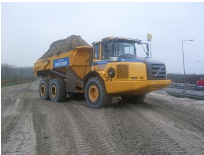
Dumpers vervoeren het materiaal vanaf het schip richting de werklocaties of depots
